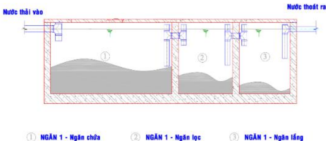
Hình 06: Sơ đồ cấu tạo hầm tự hoại 3 ngăn
